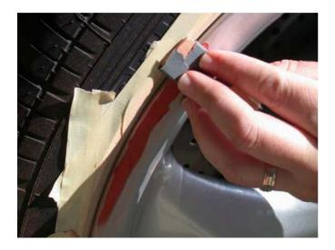
Danach wird die Reparaturstelle wieder mit SiliconEntferner reinigen. Die Felge wird nun großflächig abgeklebt und zum Grundieren vorbereitet. Der Grundierer oder Füller wird dezent im Overspray Verfahren auflackiert .
