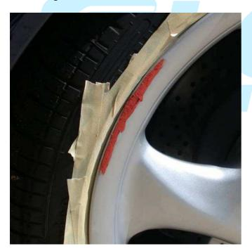
Nach der Aushärtung wird der Spachtel im Trockenverfahren geschliffen mit 240er Papier.
