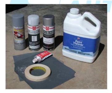
Würth Felgensilber, Nitroverdünnung, SiliconEntferner, Klarlack, Füller bzw. Grundierung, Schleifpapier z.B 240er und 600er und ein Nitrospachtel oder sogenannter Spot Kit.
