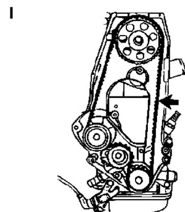
Kurbelwelle von Hand ruckfrei 2 Umdrehungen in Motorlaufrichtung drehen und anschließend prüfen, ob die Markierungen noch fluchten - gegebenenfalls Einstellung wiederholen. Zahnriemenspannung kontrollieren - gegebenenfalls einstellen - siehe Arbeitsvorgang "Spannrolle Zahnriemen grundeinstellen".
